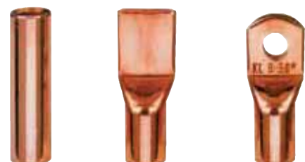
1. Ausgangsmaterial 2. Falzen und Pressen 3. Stanzen
