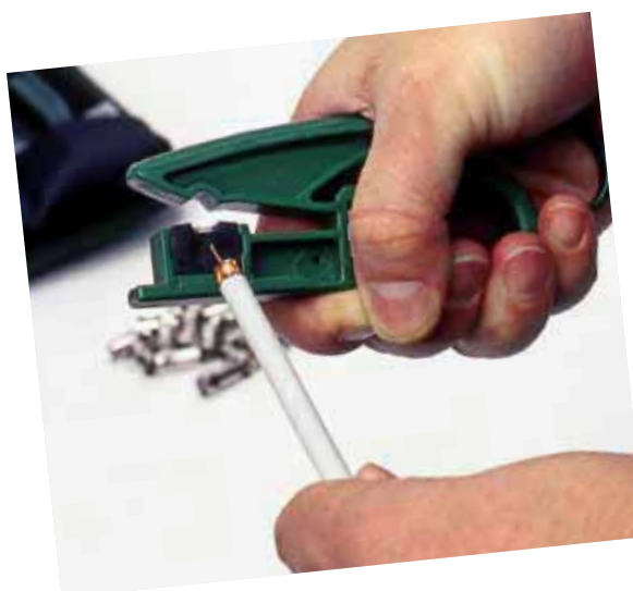
Schnelles und einfaches Konfektionieren mit den Greenlee Profi-Werkzeugen.
