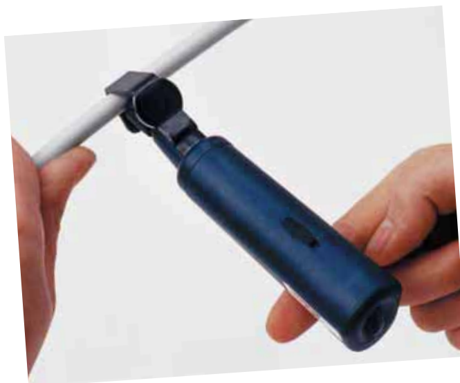
Abisolieren und Auftrennen mit einem Dreh.
