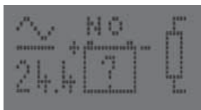
Beispiele für Diagnosemeldungen des Batteriesteuermoduls
