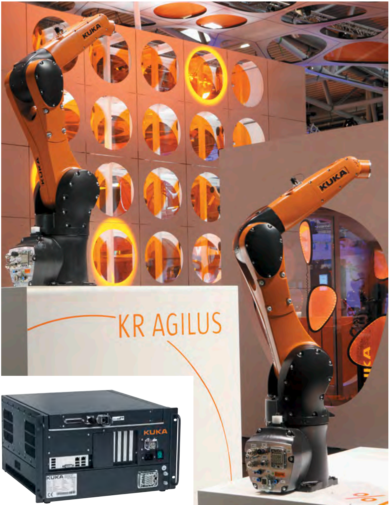
Der KR 6 R900 sixx (KR AGILUS) mit Han-Yellock® hat ein funktionelles Design für hohe technische Anforderungen.
